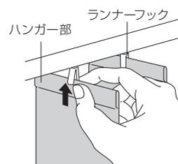
**3** 操作ボタンを回してルーバーが正常に回転するか確認してください。ルーバーが正常に回転しない場合、左図のような状態が考えられます。その場合には、ルーバーとボトムコードを正しく付け直してください。
